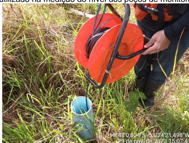
Figura 3 - Equipamento utilizado na medição do nível dos poços de monitoramento.
