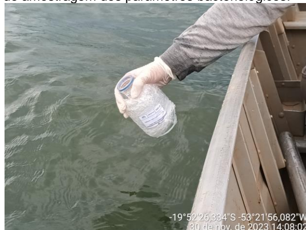
Figura 5 - Procedimento de amostragem dos parâmetros bacteriológicos.
