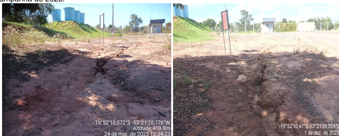
Figura 3 – Ponto 1: Erosão em sulcos, na área 1 da PCH Verde 4A no município de Água Clara/MS. Campanha de 2023.
