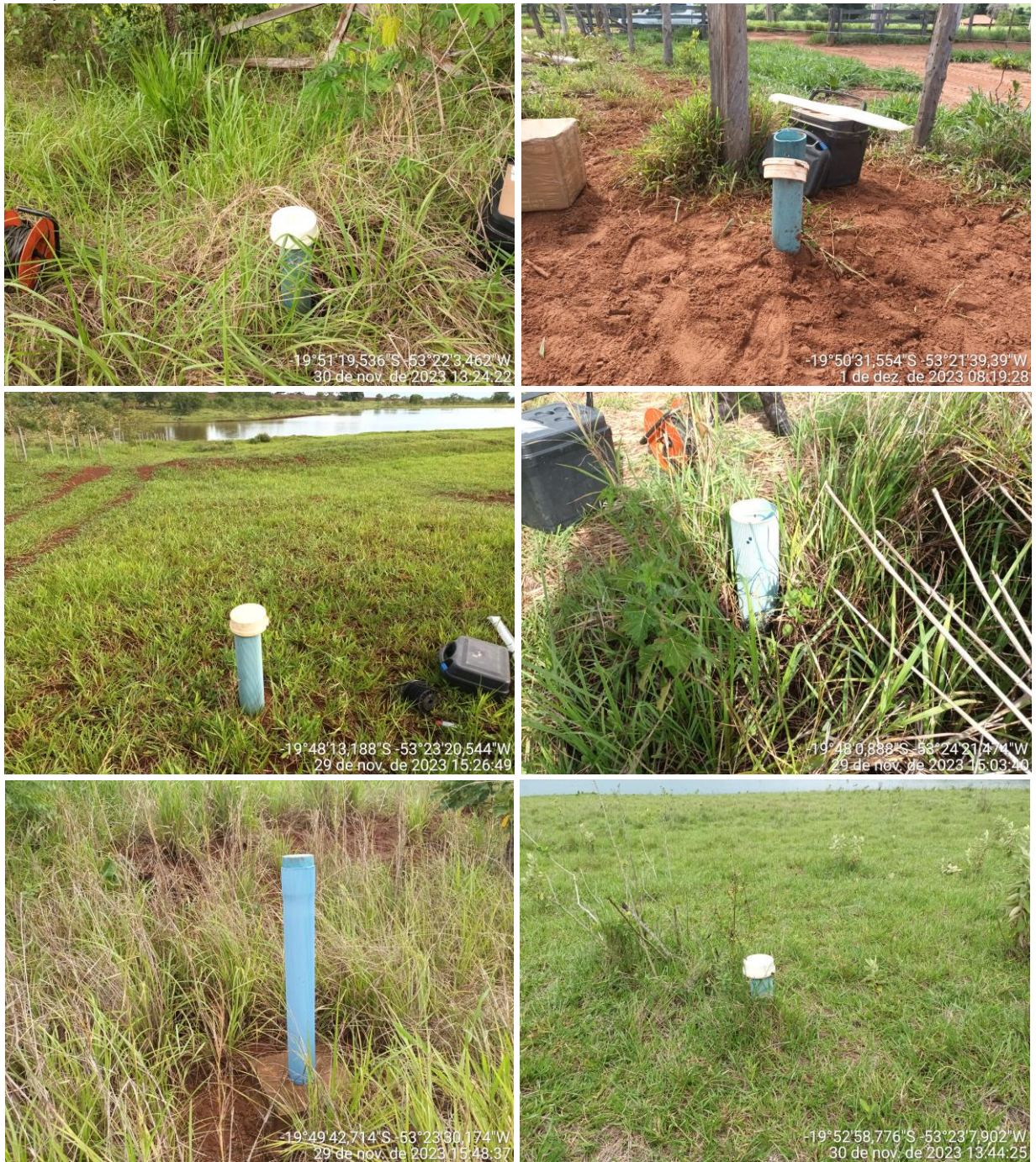
Figura 1 - Poços de monitoramento da PCH Verde 4A. Pontos de cima para baixo: P1 a P6. Campanha de novembro de 2023.
