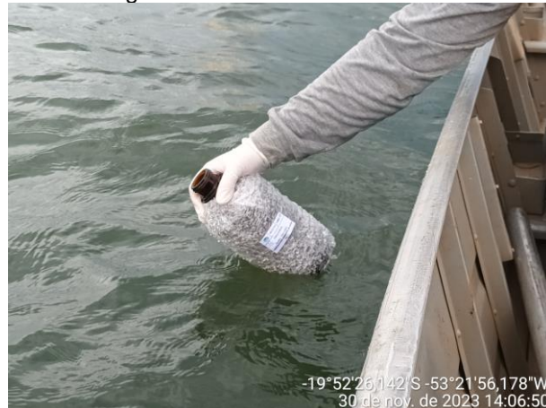
Figura 6 - Procedimento de amostragem de Clorofila-a.
