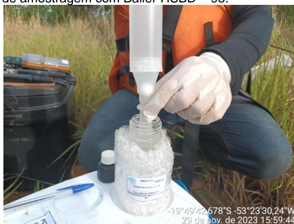
Figura 4 - Procedimento de amostragem com Bailer HSBD – 95.
